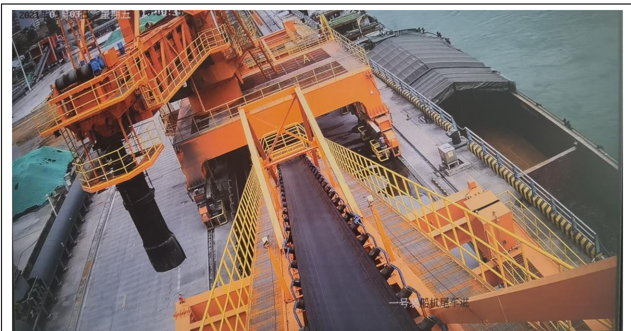
图 2.2.8-2 前方移动皮带机水平运输现状照片
